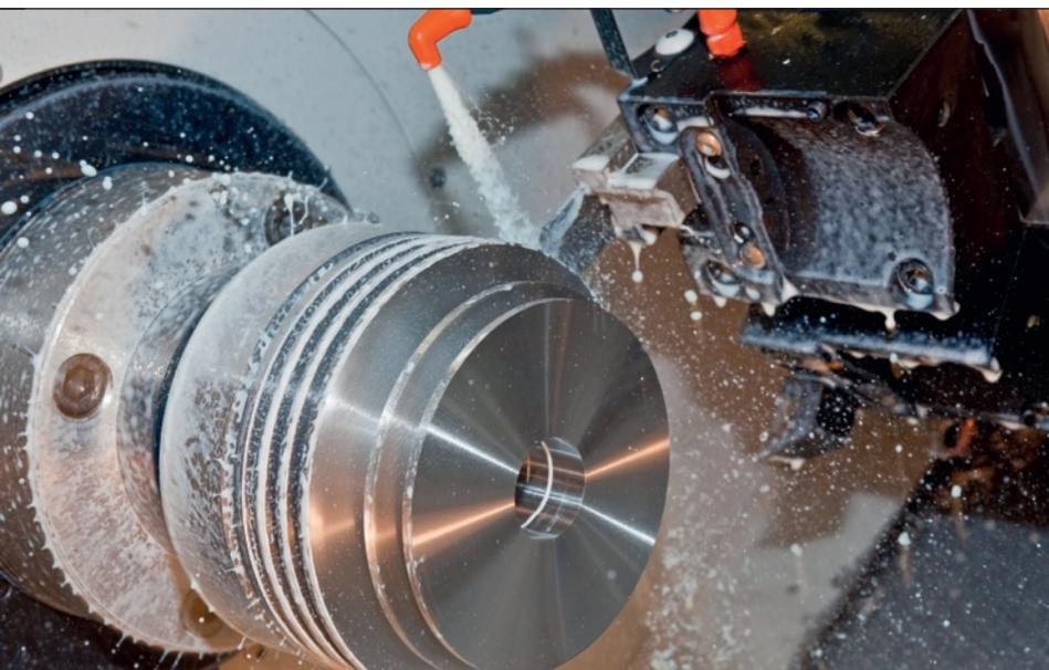
Finitura delle palette. Si nota il portautensili con ugello per l'immissione del fluido lubrificante.
