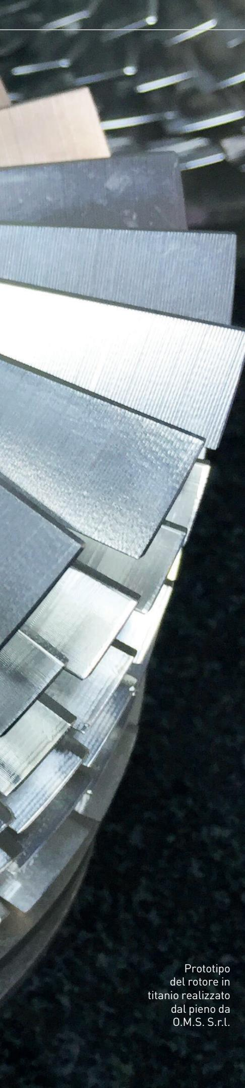
Prototipo del rotore in titanio realizzato dal pieno da O.M.S. S.r.l.
